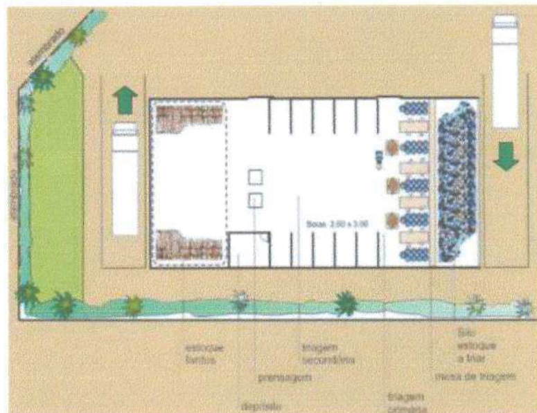
Figura 6 - Galpão de Triagem
